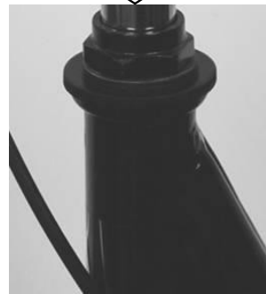
Stecken Sie die Lenkerstange in das Vorderradgabelrohr
